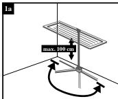
Achtung: Falls kein Platz vorhanden ist, um die Schwenkarme des Bodenständers in einer normalen Stellung über Kreuz zu platzieren, so darf die Teleskop-Höhenverstellung nur in der niedrigsten Stellung mit 100 cm eingestellt werden. Die Wäsche sollte in diesem Fall in Richtung der beiden aufgestellten Schwenkarme aufgehängt werden, da sonst eine Kippgefahr für den Wäschetrockner auftreten kann.
